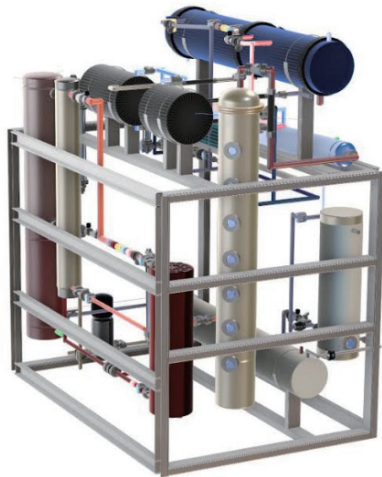
圖 2-11 改良型生質熱能吸收式製冷系統 資料來源：摘自桃園區農業改良場研究報告（2019）
