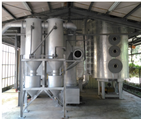
圖 2-2 國立中興大學 100 kg/hr 連續進料量產生物炭多膛爐 (吳，2018)
