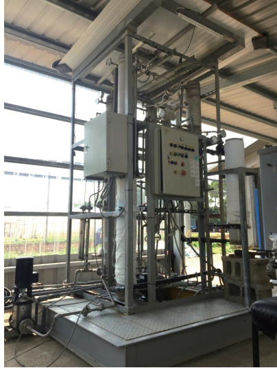
圖 2-10 生質熱能吸收式製冷系統 資料來源：拍攝於桃園區農業改良場（2018）
