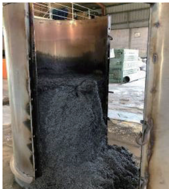
圖 2-8 製炭 TLUD 爐完成炭化
