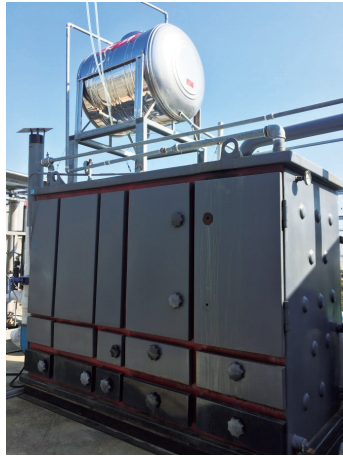
圖 2-9 多功能生物質燃燒爐
