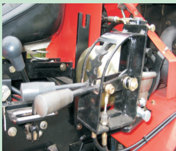
圖8. 控制施肥箱肥料出口大小之左右拉桿
