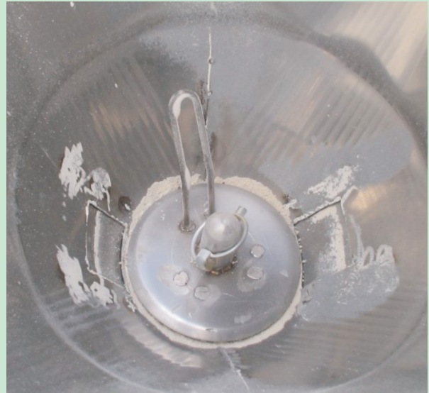
圖4. 施肥箱內下層，安裝一倒U形肥料攪拌器
