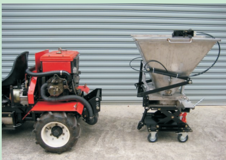
圖10. 完成本機與施肥機總成拆卸分離動作
