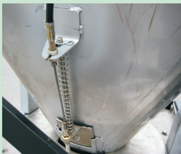
圖7. 施肥箱肥料出口大小由螺絲、伸縮彈簧及鋼索組合而成
