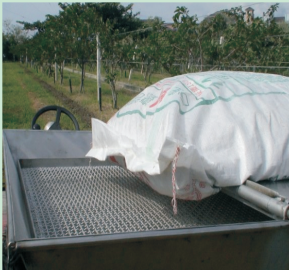
圖3. 施肥箱內上層設計一過濾網，過濾結塊肥料
