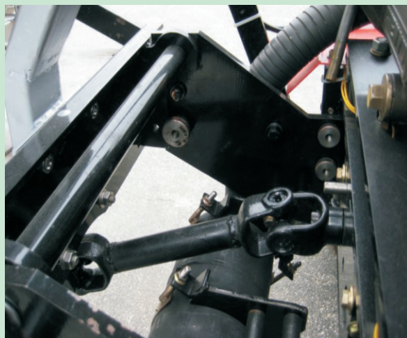
圖5. 利用PTO軸與本機出力傳動軸接合動力
