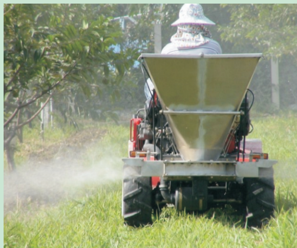
圖6. 肥料出口設計有一可調整角度活動蓋板
