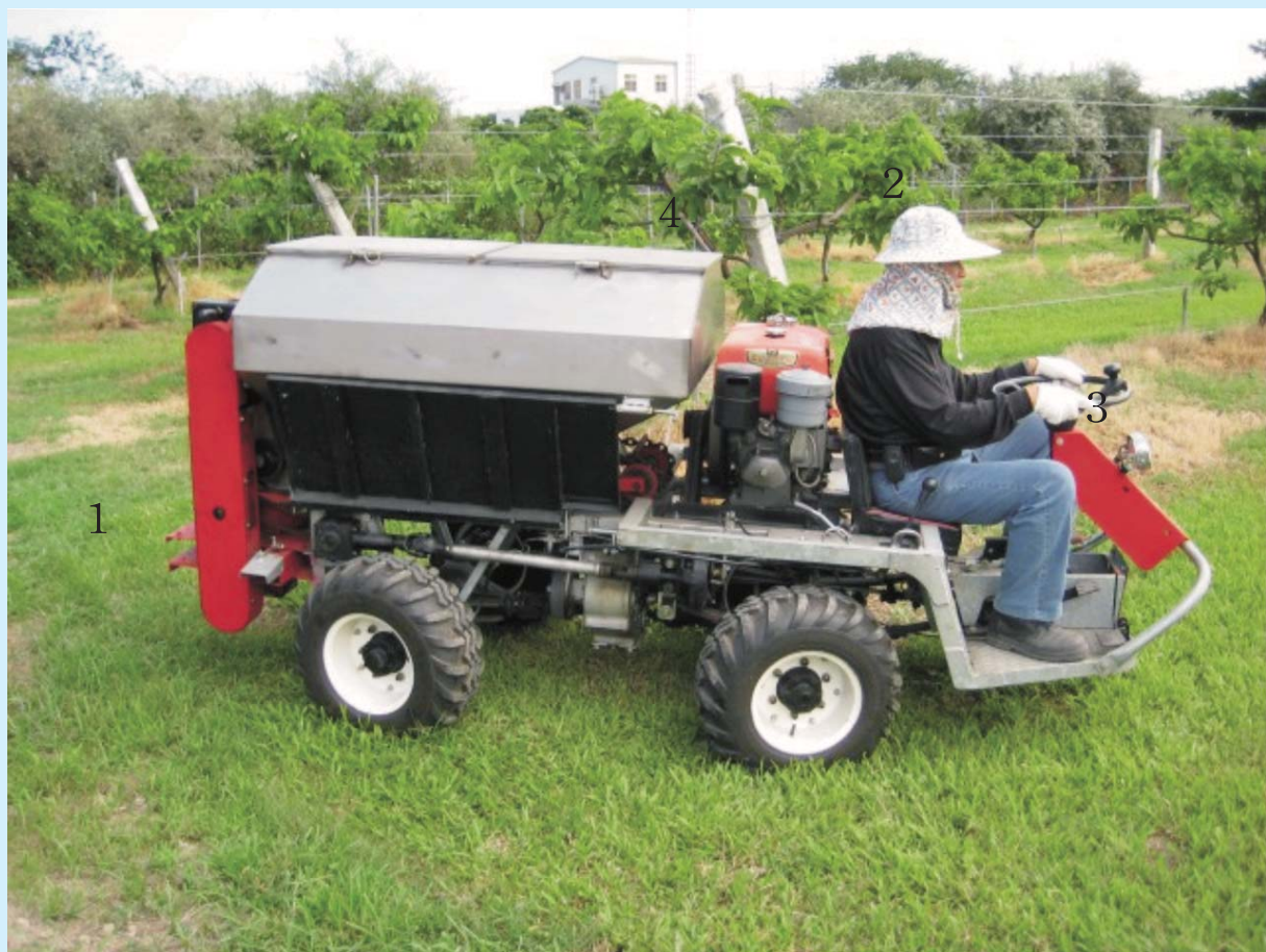
圖2.果園施肥撒布機本機四輪傳動、四輪轉向，轉彎半徑小，轉向靈活
