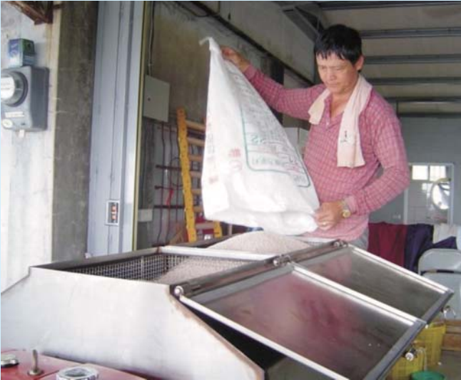
圖3.施肥箱內上層設計一過濾網，過濾結塊肥料
