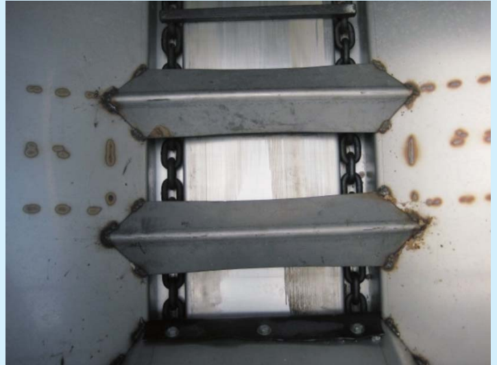
圖4.施肥箱內焊接角鐵，避免肥料集中後面，大量落下
