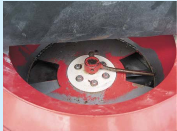
圖6.肥料承盤內設計一支轉動圓鐵條撥桿
