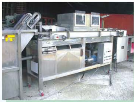
●綠竹筍清洗分級機清洗機構
