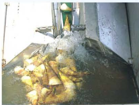
●綠竹筍清洗分級機自動供筍機構綠竹筍供筍情形
