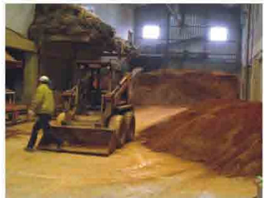
採用土壤與穀殼混合成之育苗土，可減低育苗成本與減輕苗箱重量。
