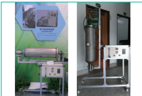
說明：殺菌機作業狀態(左)及卸料(右)狀態。
