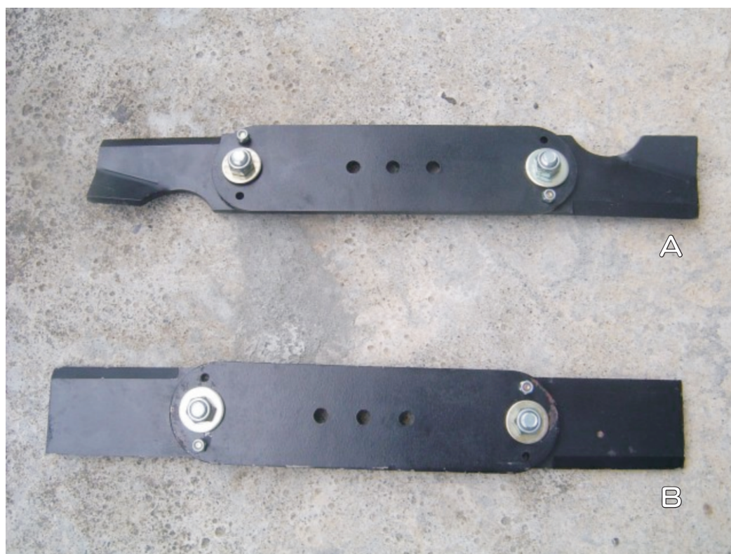
圖6. 翼形式(A)及平板式(B)割草刀片之構造
