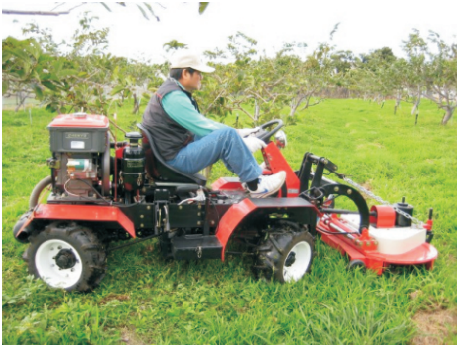
圖7. 果園割草機四輪傳動四輪轉向方式轉彎半徑小可適應各種環境作業
