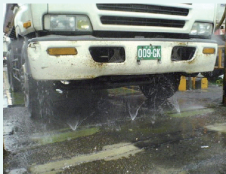
圖10. 車輛輪胎與底盤實施高壓清洗與噴霧消毒。
