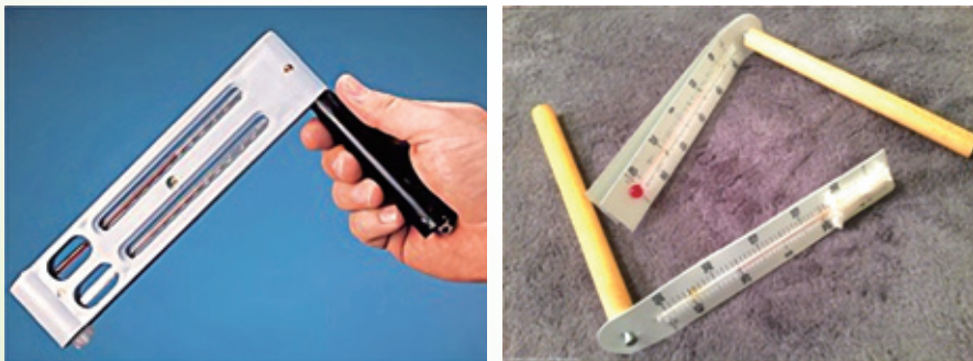
圖5.3 專業手搖式乾濕球溫度計(左)及簡易自製型(右)
