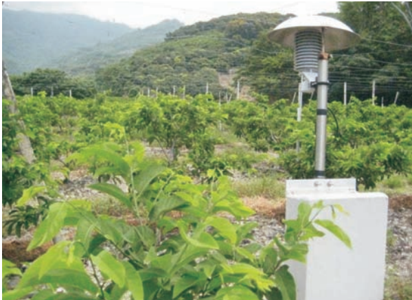
圖 18. 果園安裝焚風自動感測撒水灌溉設施 圖 19. 果園土壤水分含量及溫度感測器
