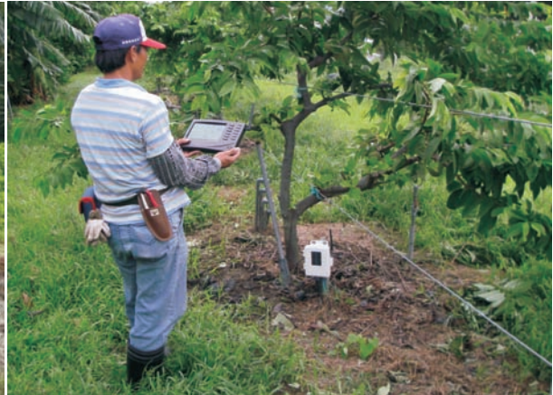
圖 18. 果園安裝焚風自動感測撒水灌溉設施 圖 19. 果園土壤水分含量及溫度感測器
