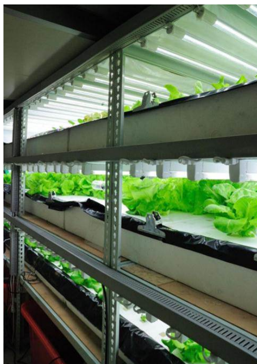
圖2. 台大的完全人工光植物工廠內部量產室一景，最上層使用LED，下面兩層使用T5螢光燈管照明
