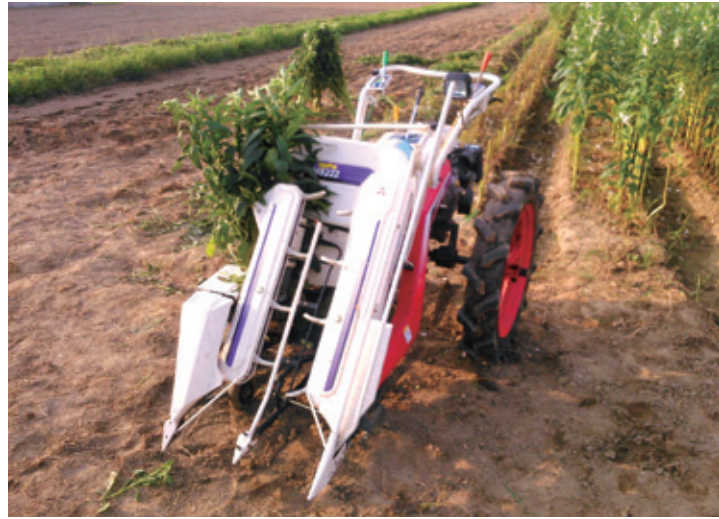
① 自走式割捆機原廠機型 ② 行走裝置改良機型
