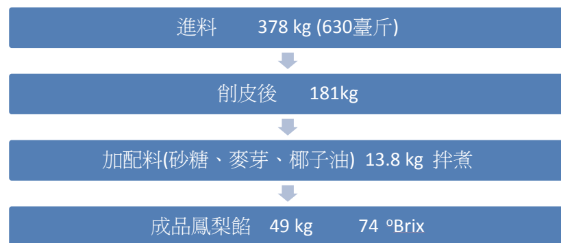
圖三、慣行栽培鳳梨製作果餡步驟及原料重量變化
