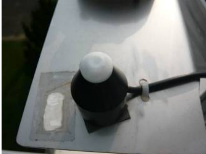
圖五、照度計之感測元件
