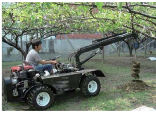
油壓鑽孔機操作簡易安全
