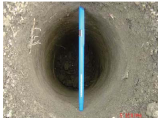
人工手持鑽孔機鑽出的孔徑小
