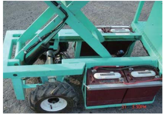
電動自走鼓風噴霧機底盤結構
