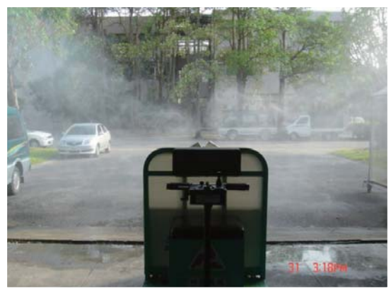
電動自走鼓風噴霧機鼓風輔助霧粒飛灑區域大
