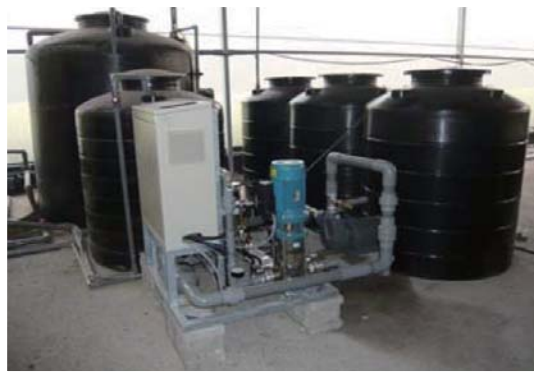
養液自動灌溉系統結合滴灌或微噴灌，省水省肥省工
