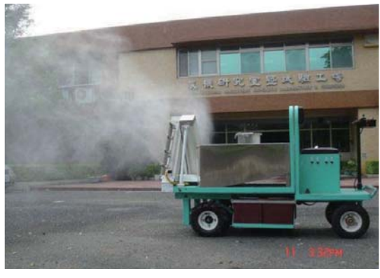
電動自走鼓風噴霧機噴霧霧粒飛灑情形
