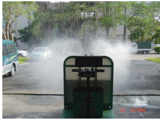
電動自走鼓風噴霧機沒有鼓風霧粒飛灑區域小
