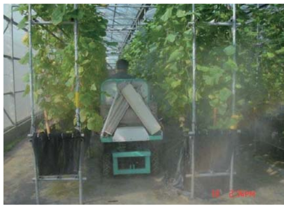
電動自走鼓風噴霧機溫室內實際噴霧作業
