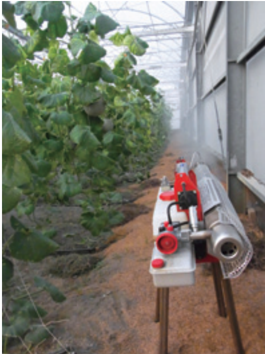
↑熱霧機進行設施洋香瓜蟲害防治試驗
