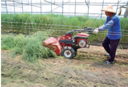
↑應用已修改刀具之碎枝機，在田間碎化割除後老化母莖操作情形
