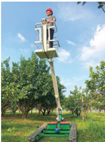
電動履帶式高空作業車舉升高度達2.8公尺
