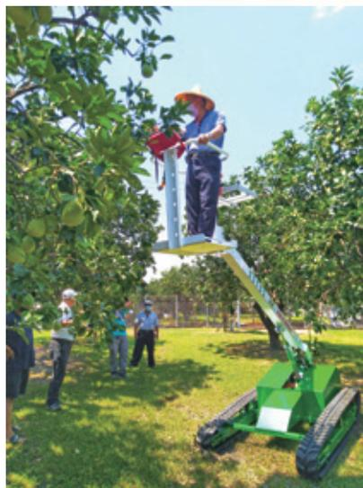
電動履帶式高空作業車與果園之操作
