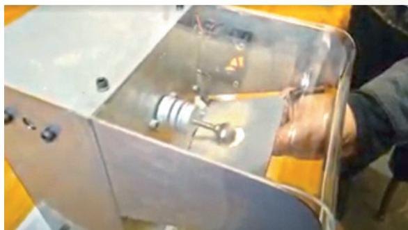
大蒜磨根機具有設計可擴充多組作業區，藉由同一動力源，擴充多單元機台
