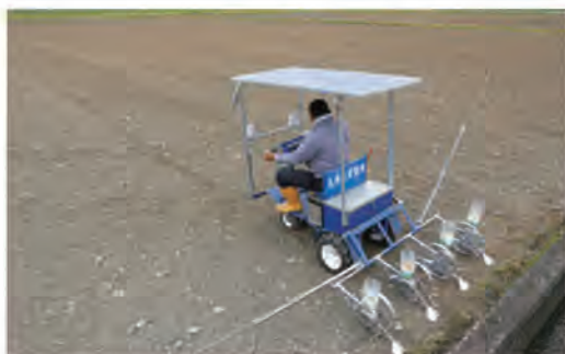
圖3. 乘坐式太陽能車附掛式雜糧播種裝置之作業情形
