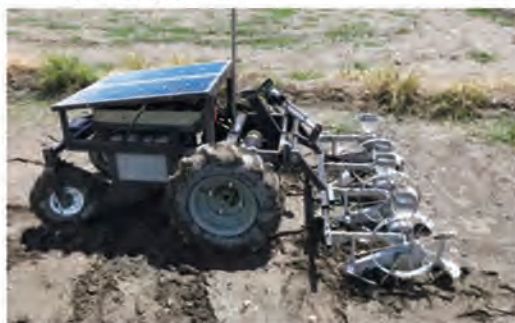
圖4. 附掛式雜糧播種裝置安裝於無人自走車上進行自動播種作業
