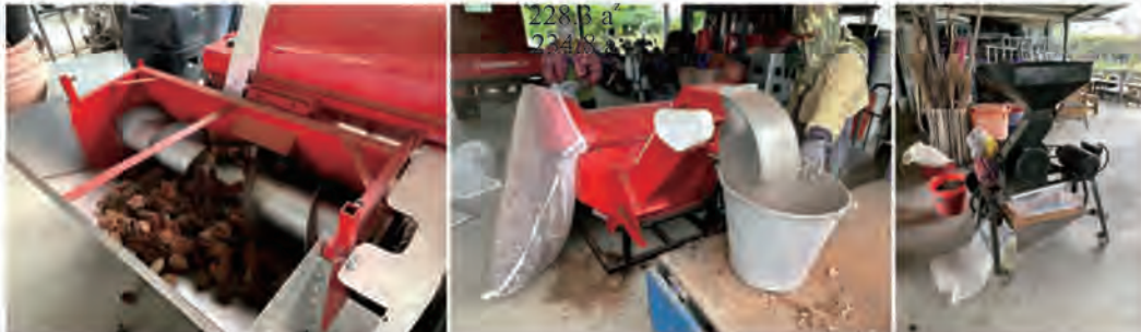
圖3. 利用本場改良之臺灣藜脫粒機及小米脫粒機可大幅提升胭脂樹採後處理效率
