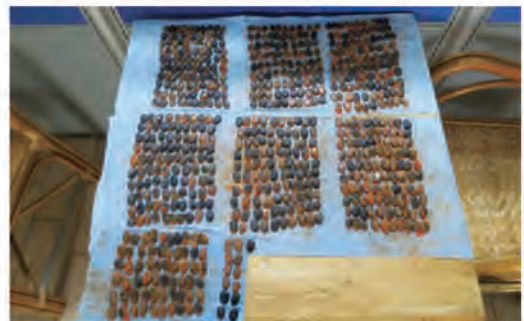
圖4. 作業後種子破損率為1%以下
