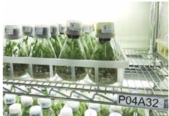
圖 3-23、組培瓶苗智慧化生產管理系統結合 QRcode 條碼管理方式，達到便利省工之資料收集。
