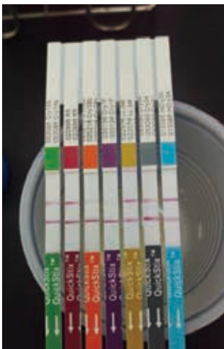
圖 5-10、Envirologix 公司出品之 Quickstrix 7 合一玉米檢測試片用於進口飼料玉米抽檢樣品檢測
