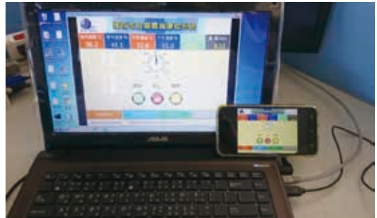
圖 3-11、支援遠端控制功能（手機、NB）
