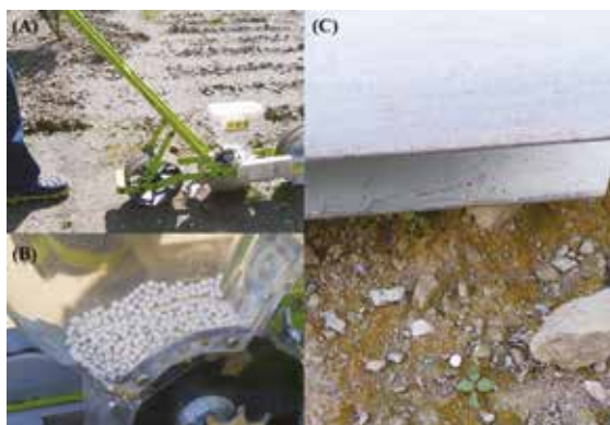
圖 1-2、臺灣藜造粒種子機械播種情形。播種機外觀 (A) 臺灣藜造粒種子於播種機內之情形 (B) 播種於田間之情形 (C)
