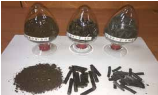
圖 3-6、廢菇包介質原料（左）、造粒（中）與生物炭（右）
