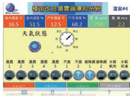
圖 3-22、種苗場溫室環控系統主頁面。
