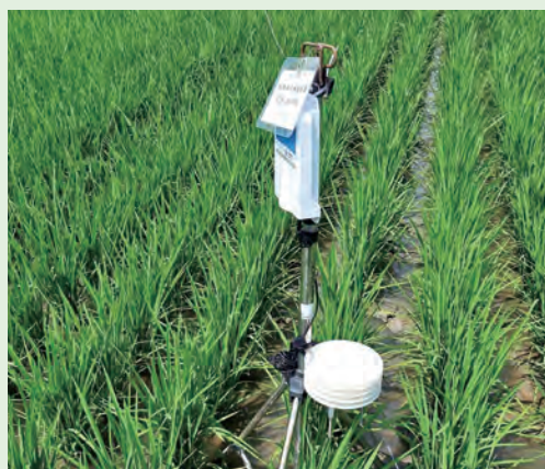
▲ 建構稻熱病預警模式—田間設置微氣象站
