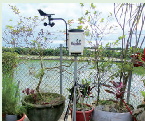
▲ 建構稻熱病預警模式—田間設置大氣氣象站
