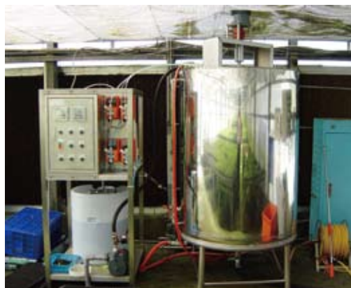
▲洋桔梗育苗用養液酸鹼、EC自動控制系統
