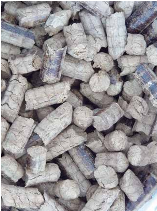
圖 2. 利用竹加工剩餘資材產製竹質燃料顆粒。 Fig. 2. Bamboo fuel pellet made by using bamboo processing residue.
