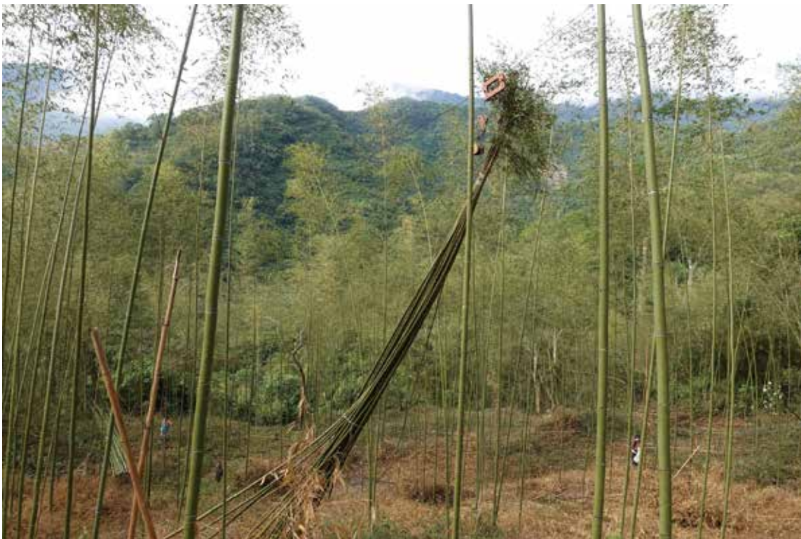
架空索集材可降低採運作業對環境之衝擊。圖為於台東縣延平鄉桂竹人工林以架空索進行集材作業。
