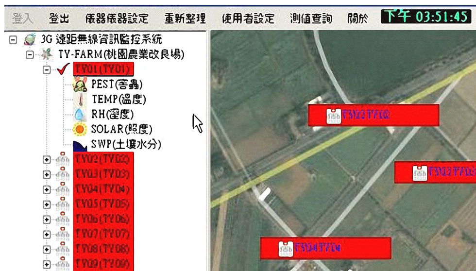
圖 2. 害蟲遠距監控系統控制介面
