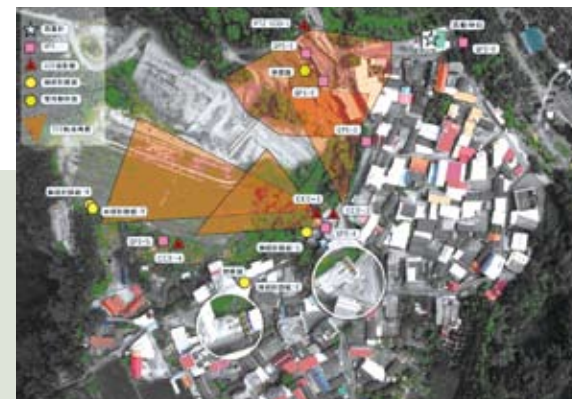
坪頂村崩塌地監測儀器配置圖
