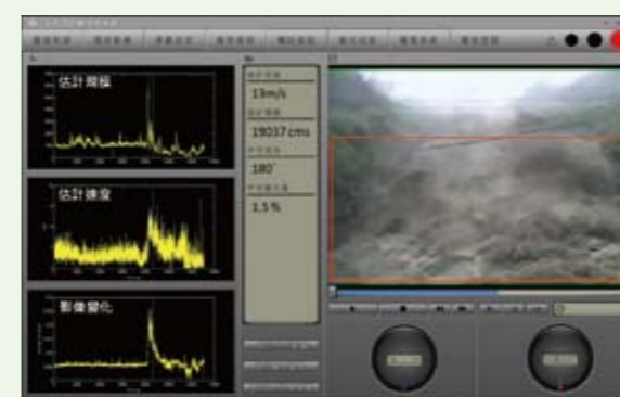
土石流影像分析雛型系統
