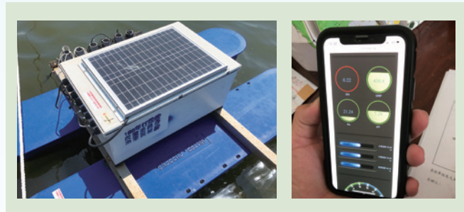
智慧養殖4.0系統（包含溶氧、酸鹼值、氧化還原電位ORP、鹽度、溫度、鈉，左：主機，右：手機App畫面）
