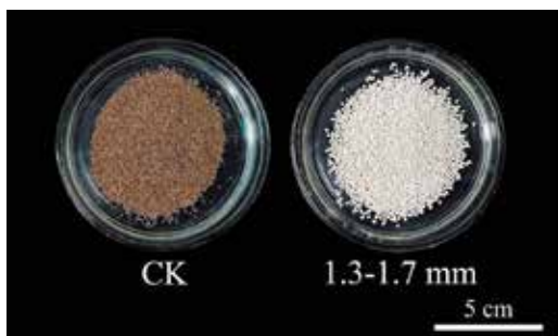
圖 6-4、以流動噴霧造粒機造粒前後之百慕達種子對照
