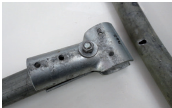
▲螺絲組裝數不足之管夾組件
