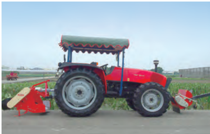
▲試驗研究曳引機前置除芋葉及後置採收挖掘機械化作業
