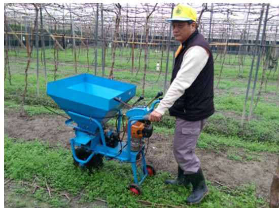
手扶自走式施肥機結構操作情形
