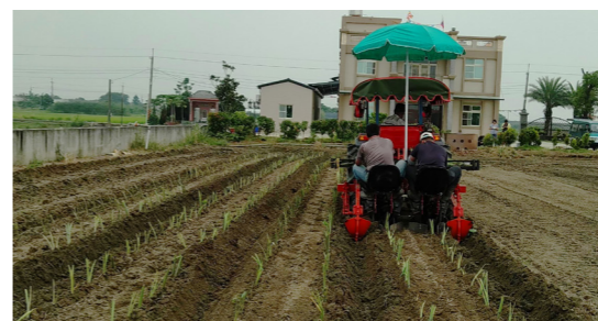
▲ 附掛雙行式芋苗種植機田間作業測試
