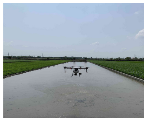
▲ 應用無人機進行水田直播，操作簡單、速度效率高，且可適用於土壤過於鬆軟的田區
