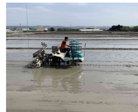
▲ 水稻濕田直播機，與傳統插秧機操作方式相似，農民不需花時間學習操作
