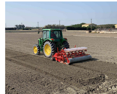
▲ 水稻乾式直播機具可與雜糧播種機通用，進行高效播種作業
