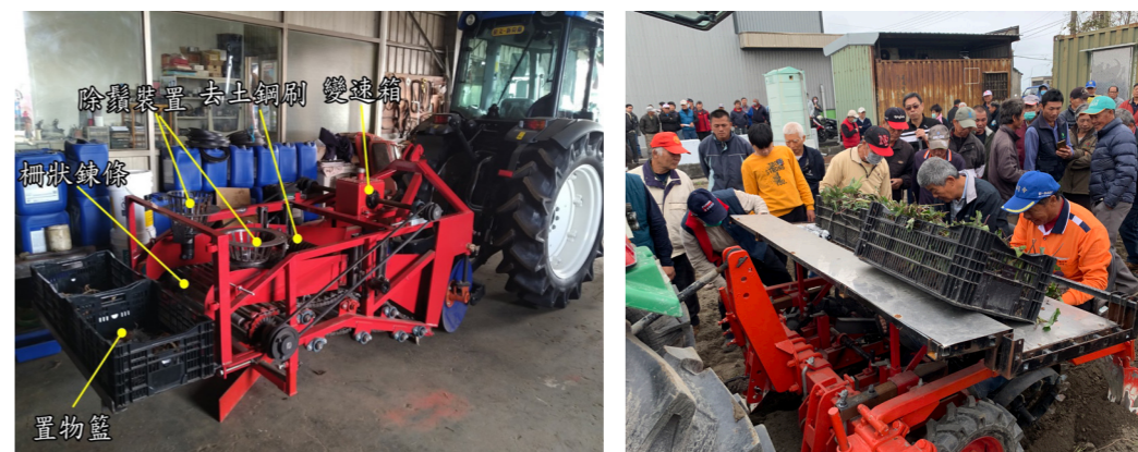
▲ 母芋收穫機之柵狀挖掘鏈條與鋼刷結構雛形機設計與配置說明
