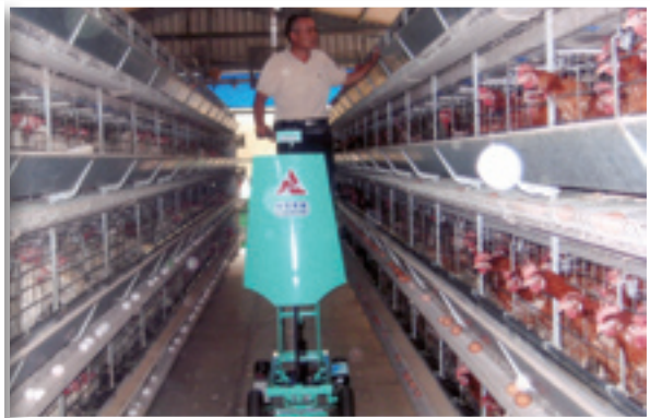
■ 升降作業機於立體雞舍巡場作業
