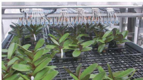
⑥蝴蝶蘭全自動澆水機採用萬向輪可直行及橫移，並且可以藉由遙控操作，較以往更為方便及省力
