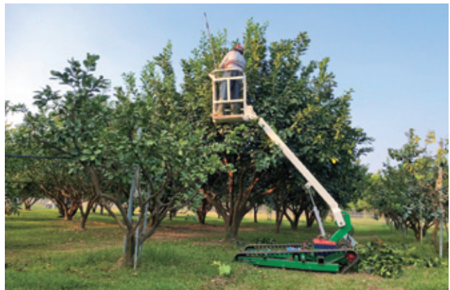
4 高空作業車達到安全性同時，亦提升作業效率50%以上
