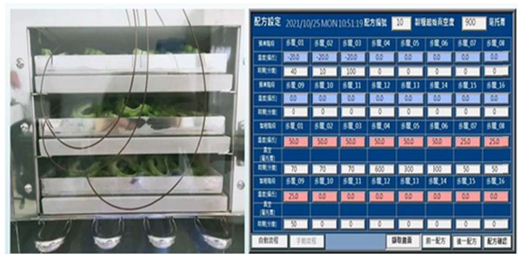
圖 2. 利用冷凍乾燥濃縮及微細化等加工技術，將格外品毛豆及綠苦瓜分別製成凍乾粉，期開發高機能性複方產品。
