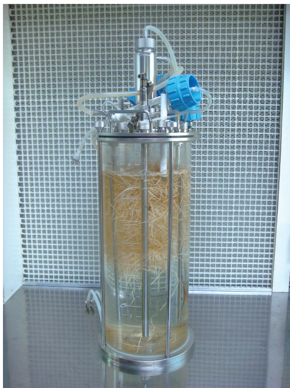
青脆枝毛狀根培養於10-L氣舉式生物反應器。
