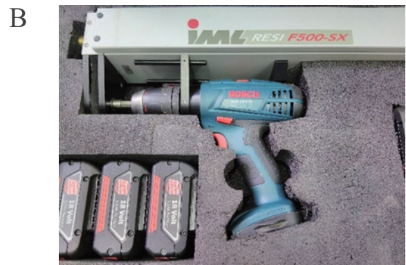
高雄市列管特定紀念樹木白千層及非破壞檢測儀器(A. ArborSonic 3D · B. IML, RESI F500-SX)。
