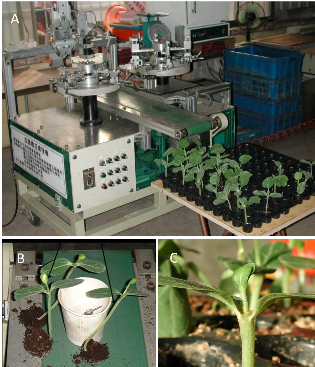
圖 9 西瓜嫁接機外部型態(A)、以西瓜嫁接機成功嫁接之西瓜苗株(B)及西瓜機械嫁接苗存活生長情形(C)。
