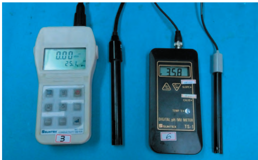
圖 1. 左圖為電導度計之本體及感應桿，右圖為酸鹼度計之本體及感應桿
