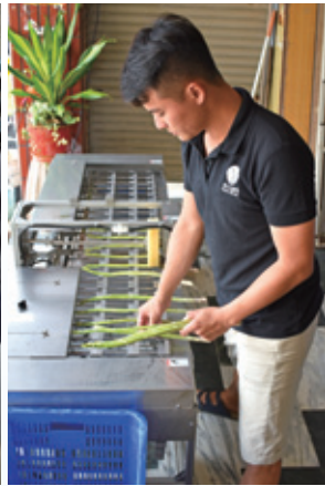
⑩ 百大青農自行購置小型選別機之投放嫩莖作業(廠牌及機型依序為圖左：ORGIWARA-3n 圖中：ORGIWARA-3修改版 圖右：NAVIC-777-TW)
