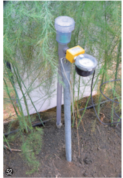
⑤2 使用土壤水分張力計監測含水量
