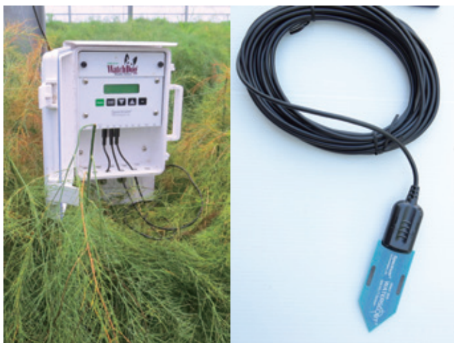
⑤③ 應用微型氣象站搭配插入土中之電路板式EC感測器，隨時監測土壤EC值變化狀況
