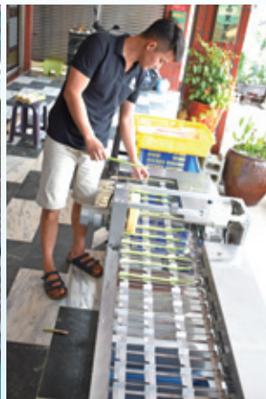
⑪ 小型選別機之自動秤量分級實況(廠牌及機型依序為圖左：ORGIWARA-3n 圖中：ORGIWARA-3修改版 圖右：NAVIC-777-TW)
