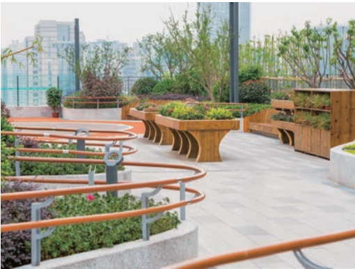
花園步道採用防滑鋪面，設置扶手鼓勵高齡者安全運動； 並設置無障礙高架花檯，設計容膝空間方便輪椅使用者操作與高齡者免彎腰 (GVL 怡境國際集團提供)
