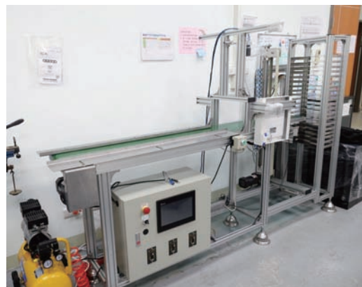
圖 3-27、水稻幼苗數位化影像評鑑系統—硬體：由左至右分別為進料輸送帶、檢測區及出料區
