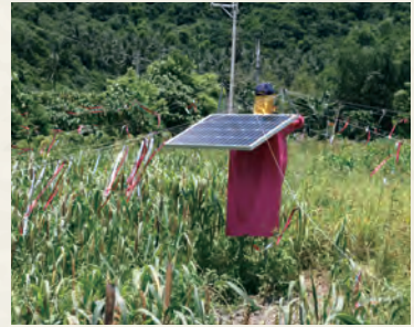
圖 4 | 太陽能人型驅鳥器田間運作情形為害
