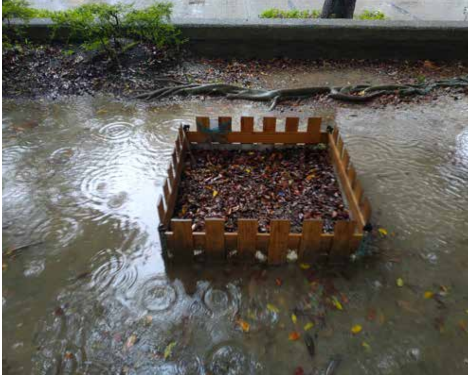
大雨時土壤實驗樣區周邊已經淹水，但樣區不但沒有淹水，還迅速把水排乾了。 攝影：張文誠
