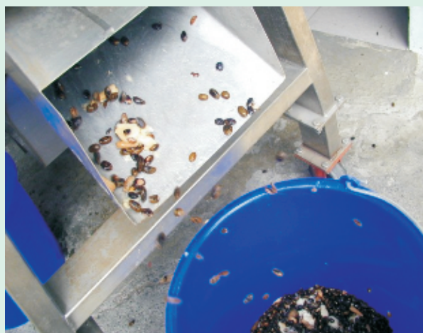
圖12. 種子從排出口中排出的情形
