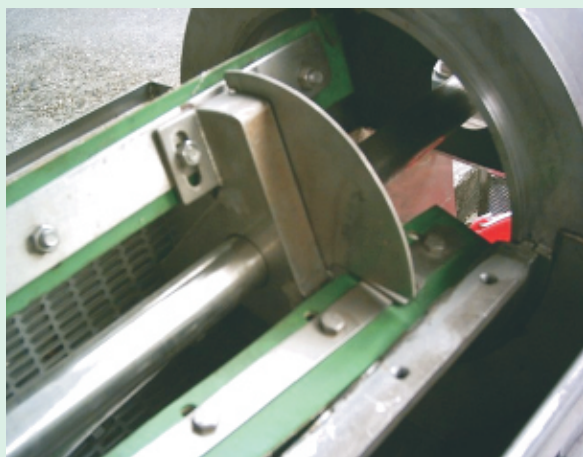
圖5. 篩網與刮板的間隙及三片阻擋板的間隙口
