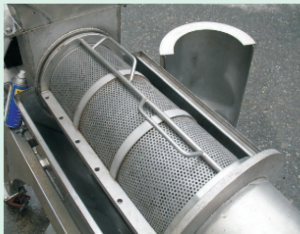
圖3. 圓桶型篩網分成覆蓋及上、下兩片篩網可輕易拆裝
