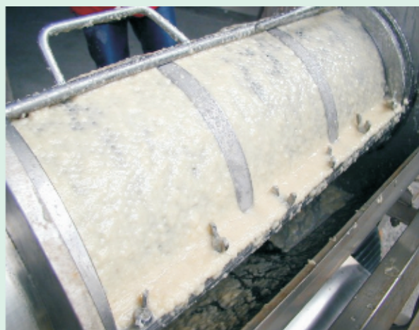
圖11. 果漿經由篩網孔徑排出情形
