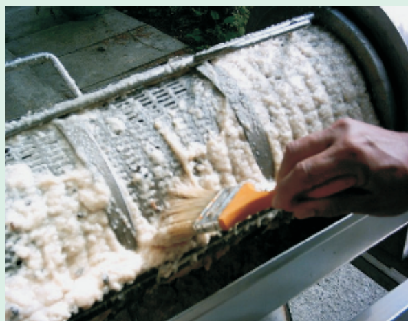
圖20. 使用毛刷以刷落果漿
