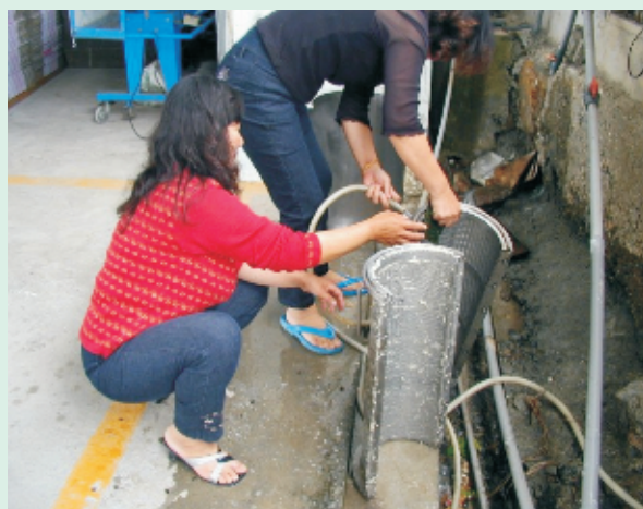
圖21. 分離機篩網拆卸清洗作業
