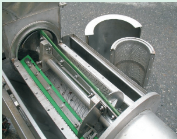
圖3. 圓桶型篩網分成覆蓋及上、下兩片篩網可輕易拆裝
