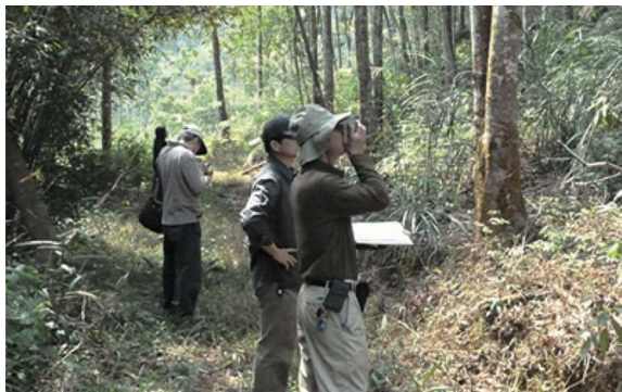
山坡地土地可利用限度查定－坡度測量 照片來源：《滴水培土－守護大地一世情》，民國 102 年
