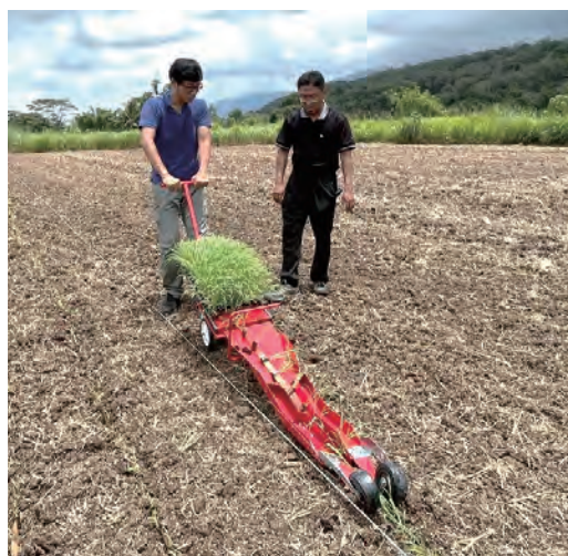
圖2、利用單行式移植機種植小米
