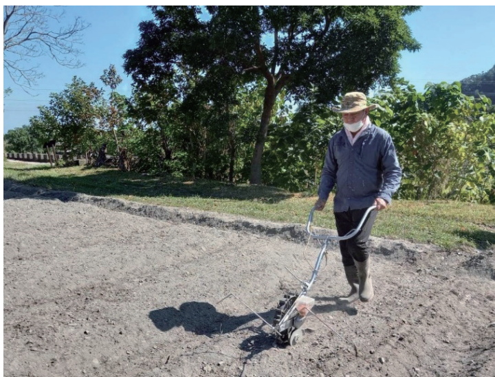
圖1.單行手推播種器田間播種情形。
