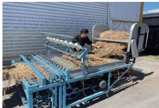
圖2、稻草鋪平機械配合編織機械可單人作業
